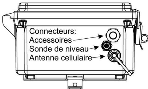
Prévoir 5 cm (2 pouces) à droite du boîtier si la fermeture par loquet est utilisée.
