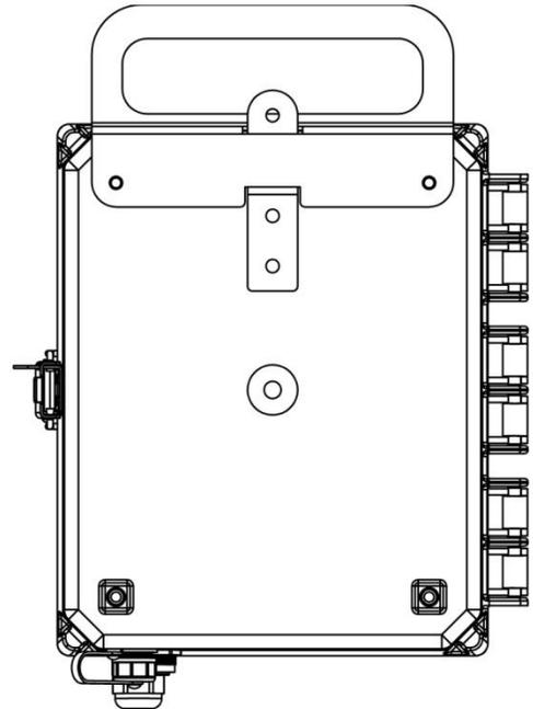
Prévoir 15 cm (6 pouces) sous le boîtier pour connecter l'antenne, la sonde de niveau et autres accessoires.
